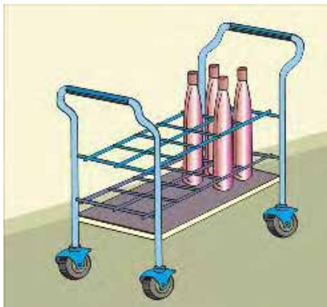
شکل ۷-۳: چرخ دستی مخصوص که برای حمل و نگهداری صدا خفه کن های موتور سیکلت طراحی شده است.
