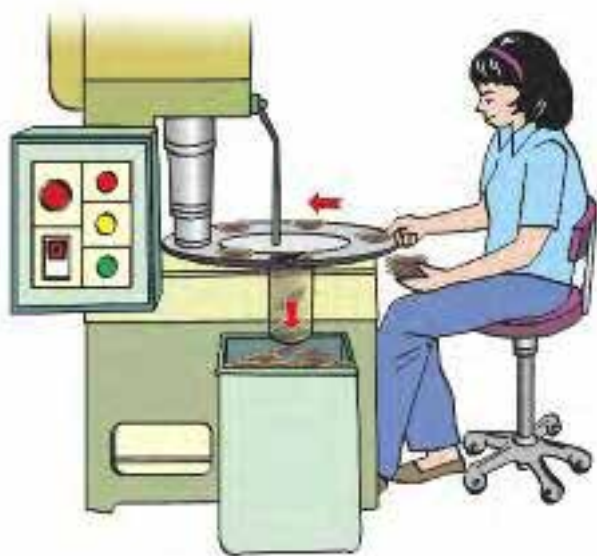
شکل ۴۶-۱: دستگاه پرس با تغذیه گردونه ای
