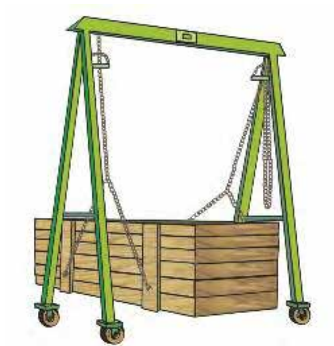
شکل ۹-۱: جرثقیل متحرک برای حمل بار سنگین وزن در مسافت کوتاه با حداقل ارتفاع، وسیله ای قابل اطمینان، ایمن و عملکرد آسانی نیز دارد.
